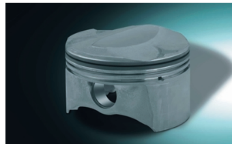
Bild 4: Kolben für V8-Motor, Werkstoff KS1295, örtlich begrenzter Schutz der 1. Nut durch Hartanodisierung, Ferrocoat-beschichtet
